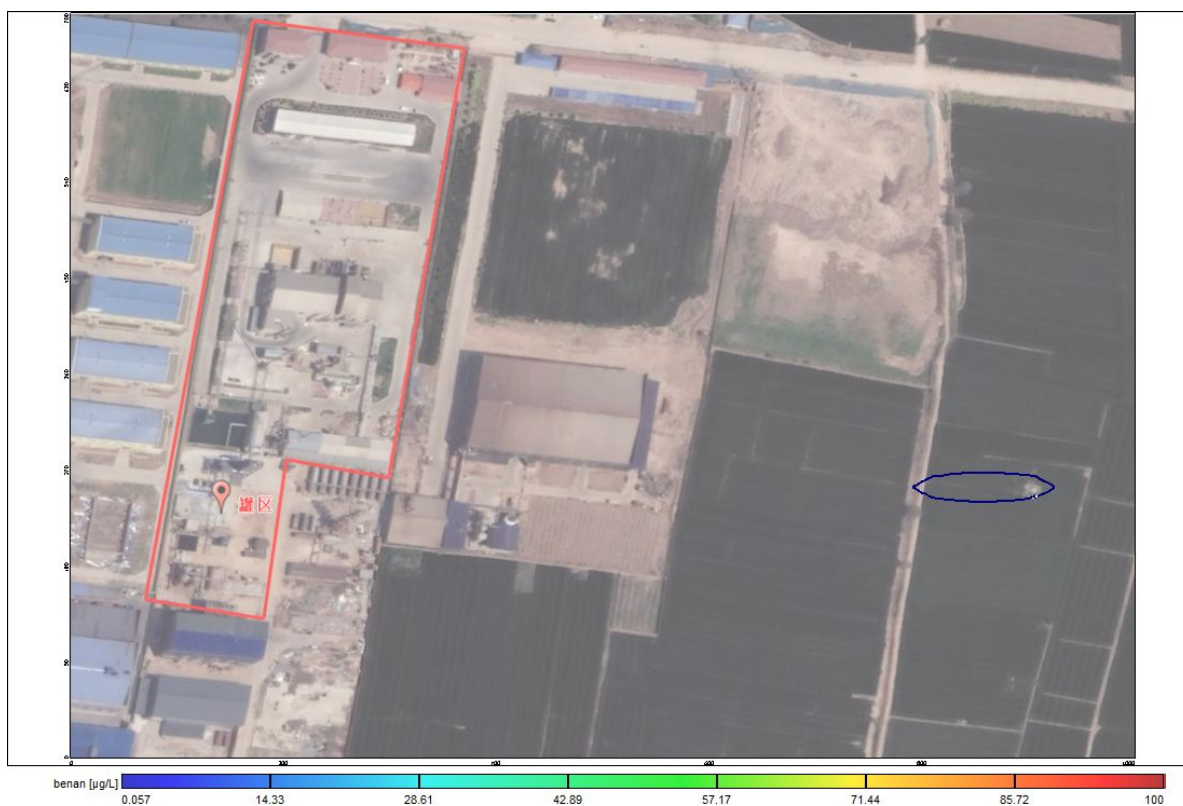
图 5.2-28 非正常苯胺在潜水层迁移 1000d 迁移图
