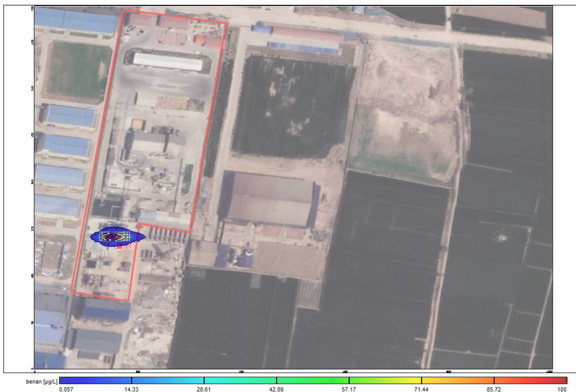
图 5.2-26 非正常苯胺在潜水层运移 100d 运移图
