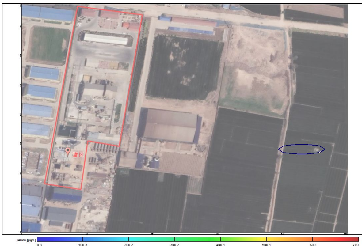
图 5.2-25 甲苯在潜水层运移 3650d 运移图
