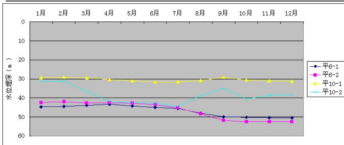
图 4.1-3 平乡县浅层地下水水位动态变化曲线图
